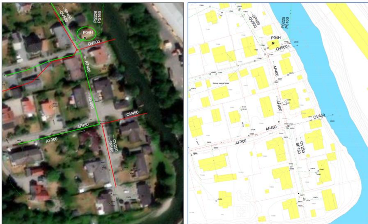
Figur 4 Kart over eksisterende avløpsanlegg i området ved Frogneskroken. Spillvann (og fellesavløp) er i figuren til venstre indikert med grønt, og overvannsledninger med rødt.
