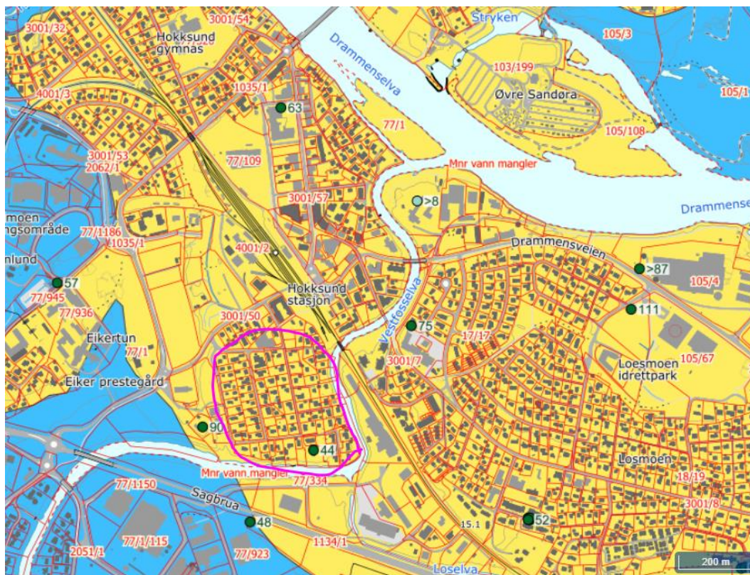
Figur 16: Løsmassefordeling i Frognes (rosa ring). Blått indikerer tykt dekke med hav- og fjordavsetninger (typisk silt og leire), mens gult indikerer elve- og bekkeavsetninger (typisk sand (og grus)). Grønne prikker med tall representerer grunnvannsborehull og dybde til fjell Hentet fra [2].
